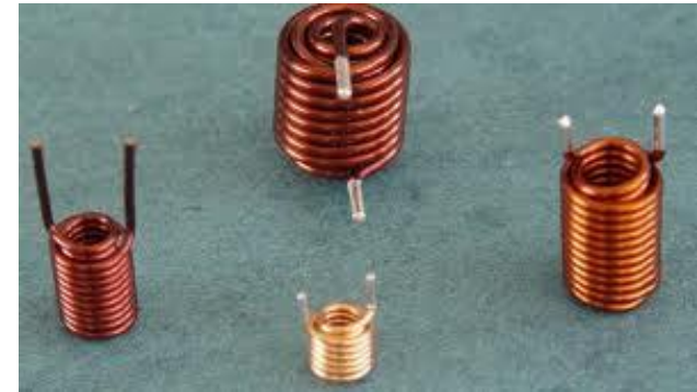
Примеры многослойных катушек индуктивности без сердечников
